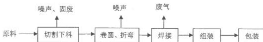
图 2-4 生产工艺流程及产物环节
